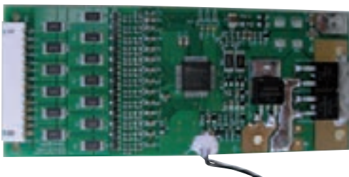
Cell Balancing für 13 Akkus, inklusive Batteriemangement und PCM
