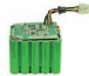
Panasonic Typ CGR-18650CG, 14,4/11,25 Ah, 45SP, inklusive PCM und Battery Management BQ20Z80.
