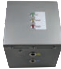
Panasonic Typ CGR-18650, 14,4V/9,011Ah, 454P, inklusive analoger 3-stufiger Kapazitätsanzeige und einem stabilisierten 7,5V/1,4A-Ausgang.
