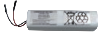
Panasonic Typ CGR-18650CG Pack 452P, 14,4V/4,5 Ah, mit PCM und integrierter 10kOhm NTC-Steuerung mit Sicherheitsrelais.
