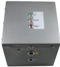
Akku Pack, 14,4V/13,8Ah, mit zusätzlicher Step Down Schaltung, 7,4V/2,0A
