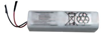
Panasonic Typ CGR-18650CG Pack 4S2P, 14,4V/4,5 Ah, mit PCM und integrierter 10kOhm NTC-Steuerung mit Sicherheitsrelais.
