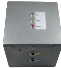
Panasonic Typ CGR-18650, 14,4V/9,09Ah, 4S4P, inklusive analoger 3-stufiger Kapazitätsanzeige und einem stabilisierenden 7,5V/1,4A-Ausgang.
