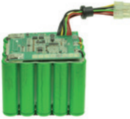
Panasonic Typ CGR-18650CG, 14,4/11,25 Ah, 4S5P, inklusive PCM und Battery Management BQ20Z80.
