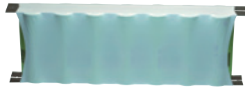
A123 Systems Pack Typ AMR 2650M1, 23,1V/2,5 Ah, 7S1P, mit PCM und Lötflächen.
