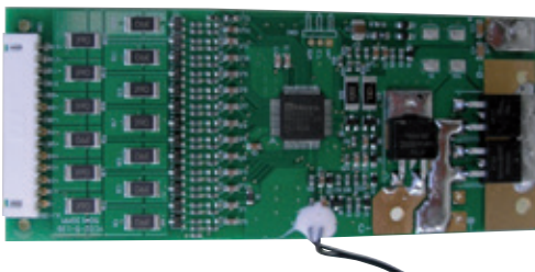
Cell Balancing für 13 Akkus, inklusive Batteriemangement und PCM
