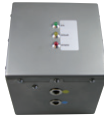
Panasonic Typ CGR-18650, 14,4V/9,09Ah, 4S4P, inklusive analoger 3-stufiger Kapazitätsanzeige und einem stabilisierten 7,5V/1,4A-Ausgang.
